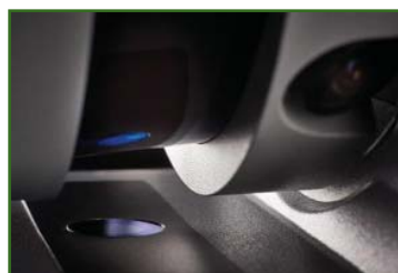
Рис. 6 Коллиматор, встроенный в подставку сканера
